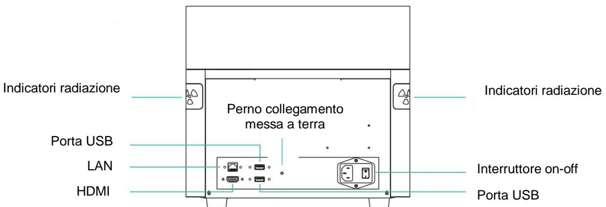
Connessioni ed interfacce Spettrometro
