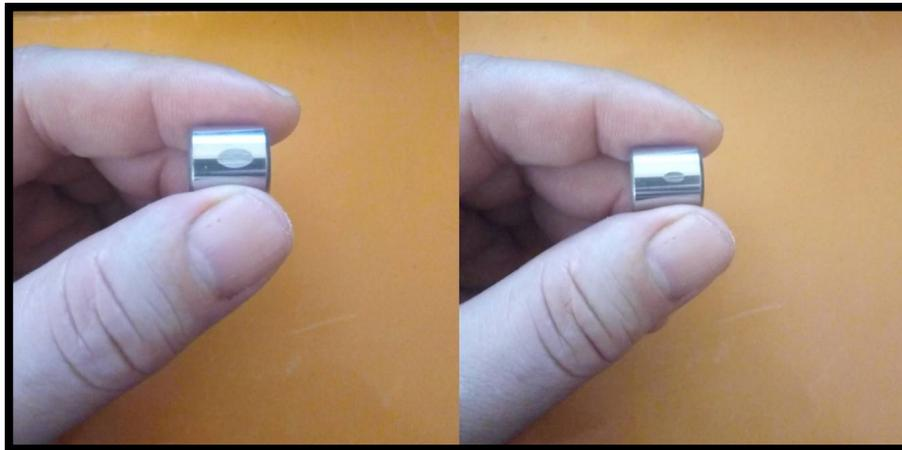
Fig. 2 – Differenza di impronta sul rullo di test tra lubrificante senza additivi anti-attrito (sx) e con additivi anti-attrito (dx)
