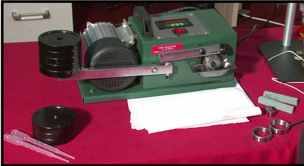
Fig. 1 Tipico set-up di test di un lubrificante con 5 dischi sovrapposti
