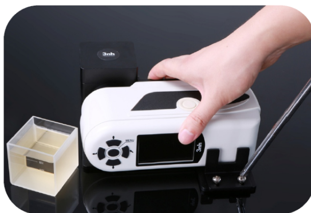
Fig. 5 Posizionamento colorimetro sul fianco e misurazione
