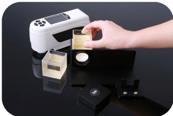
Fig. 3 Posizionamento cuvetta all'interno della sfera di integrazione
