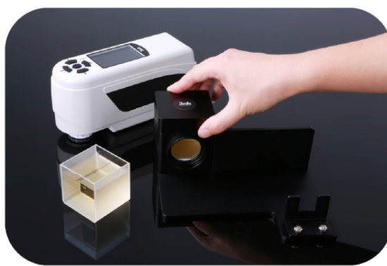
Fig. 4 Chiusura sfera di integrazione con tappo di integrazione
